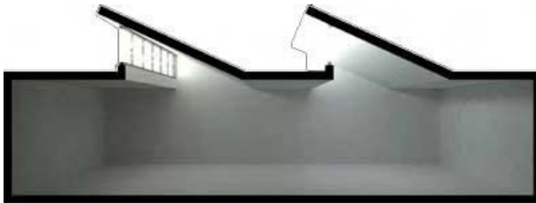
Εικόνα 54. ανοίγματα οροφής σε πριονωτή στέγη - πηγή: www.squ1.org
