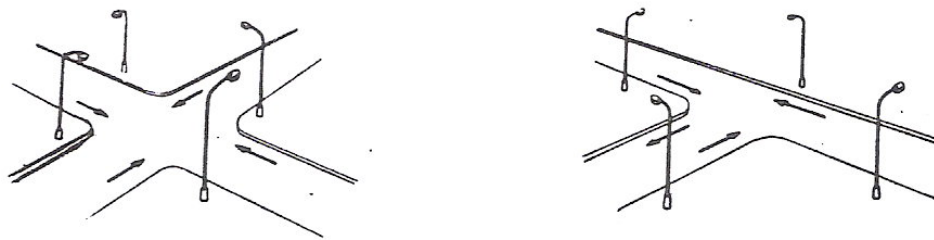
Σχήμα 3-10: Φωτισμός σε διασταυρώσεις ή συμβολές δρόμων
