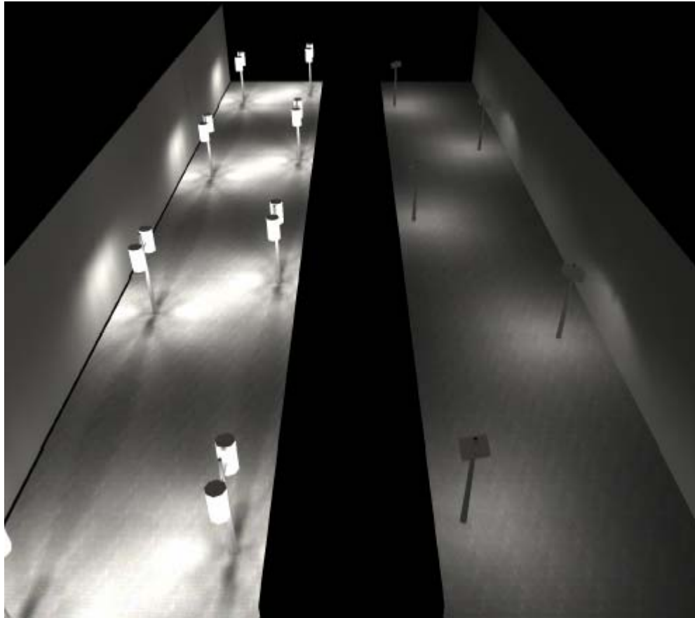
Σχήμα 6-14: Σύγκριση επιπέδου φωτισμού υπάρχουσας κατάστασης (αριστερά) και σεναρίου 6 (δεξιά)
