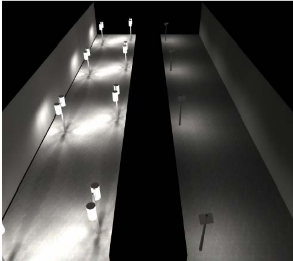
Σχήμα 6-10: Σύγκριση επιπέδου φωτισμού υπάρχουσας κατάστασης (αριστερά) και σεναρίου 4 (δεξιά)
