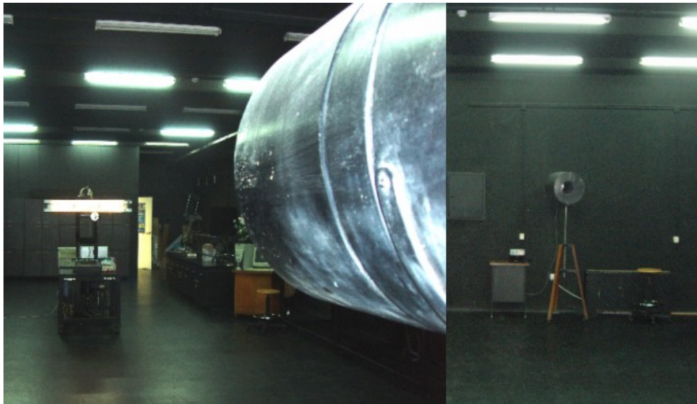
Σχήμα 3.2 : Παρουσίαση της τοποθέτησης του αισθητήρα μέτρησης φωτισμού, ο οποίος είναι προστατευμένος από παράσιτο φωτισμό μέσα σε κυλινδρικό διάφραγμα (δεξιά φωτογραφία) απέναντι από τη μετρούμενη διάταξη (λαμπτήρας και σύστημα έναυσης, αριστερή φωτογραφία) μέσα στο χώρο του εργαστηρίου (η φωτογραφία δεν έχει σχέση με το συγκεκριμένο πείραμα [4]).
